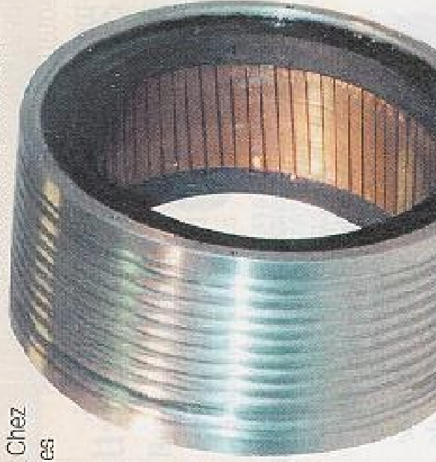
Moteur synchrone basse vitesse et à fort couple pour machine-outil
